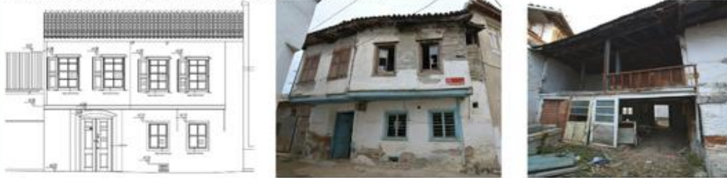
69A/20P sokak cephesi restitüsyonu ve cephe görselleri
