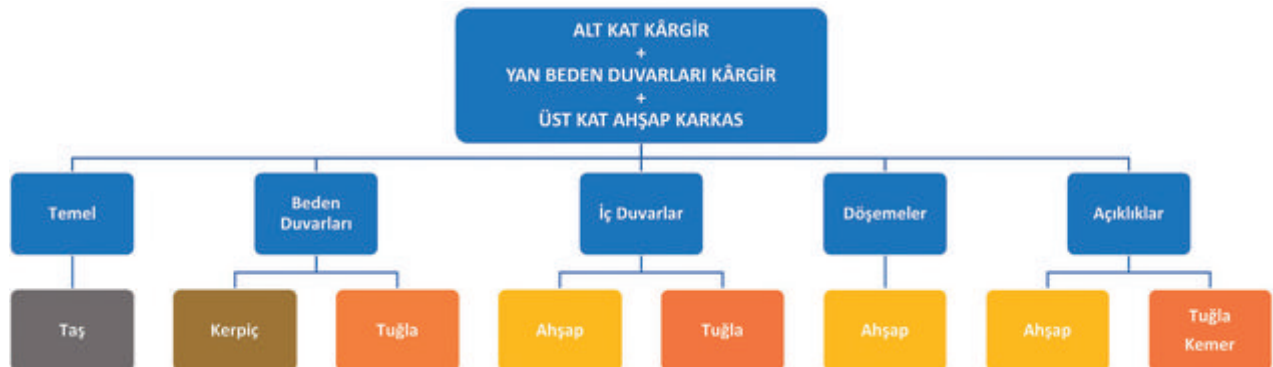
Şekil 21: Alt katı ve yan beden duvarları kâgir, üst katı ahşap karkas yapılar.
