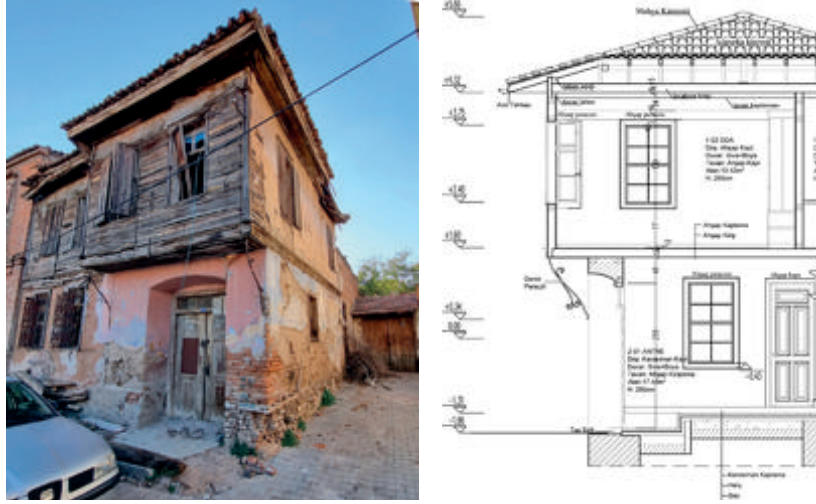
Şekil 5: 152 ada 12 parseldeki yapının cephesi (2023) ve sistem kesiti.
